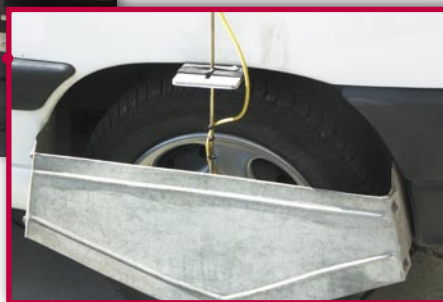
Odometr – urządzenie do pomiaru przejechanej odległości
